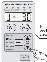
Einschaltverzögerung bei Pufferfüllstand erreicht, ist auf 3s eingestellt.
