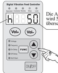
Die Ausgangsspannung wird 50V nie überschreiten.
