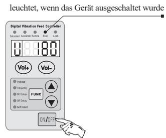
Diese Funktion arbeitet mit Hilfe eines digitalen Signals, dadurch entstehen keine Spannungsspitzen und kein mechanischer Schaltkontaktverschleiß beim Ausschalten des Vibrationsförderers.
